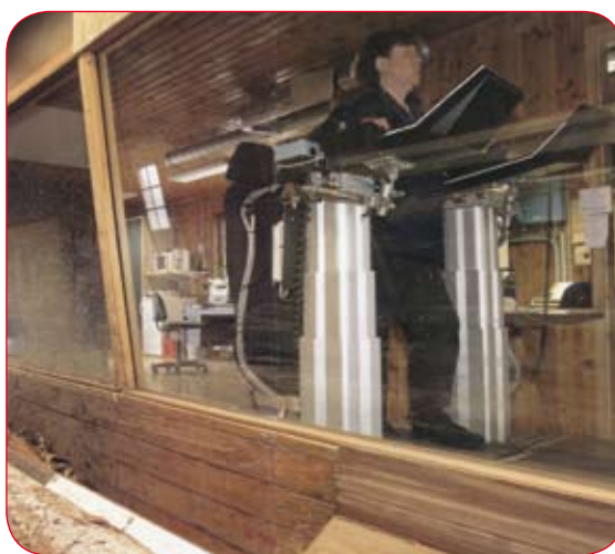
Colonne combinée avec un accoudoir et un panneau de contrôle pour l'opérateur.
