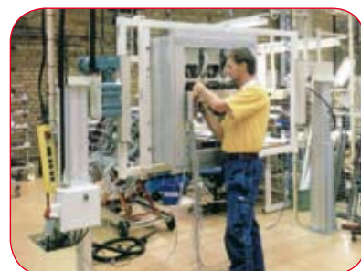
Uitgeschoven hefkolom voor optimale ergonomische positie.
