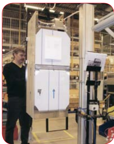
Dubbele kolombouw zorgt voor grote hefsnelheid en hoge reiklengte
