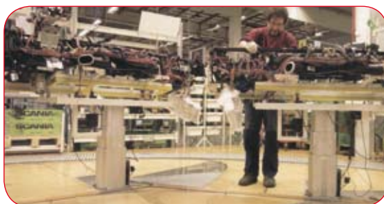
Fixtures voor 90° rotatie en 3-delenkolom in series op beweegbare tracks.
