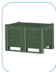
DL800AG 1200 X 800 X 740 mm Geperforeerde wanden 700 kg / 4000 kg
